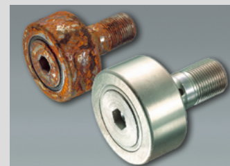
Rotella a sfere senza rivestimento (a sinistra) e con rivestimento (a destra) Corrotect dopo un test in nebbia salina
